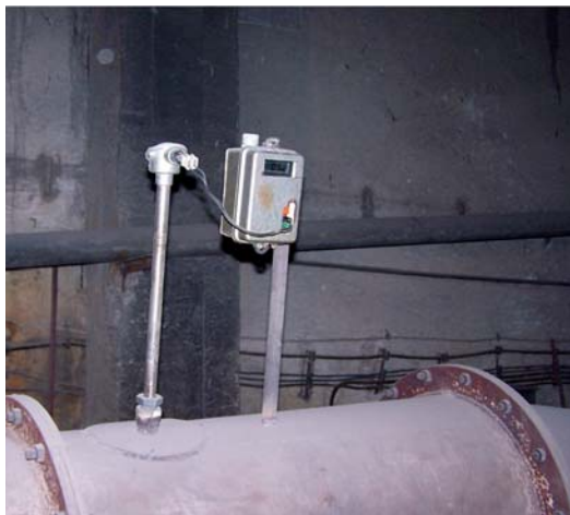
Fot. 6 „Mały” piec do wypalania klinkieru romańskiego – strefa spiekania; pomiar temperatury
