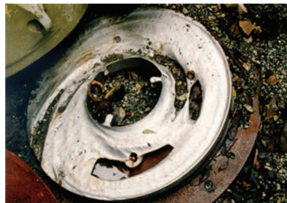
FOT. 2 Przetarta wykładzina ssania pompy konwencjonalnej
