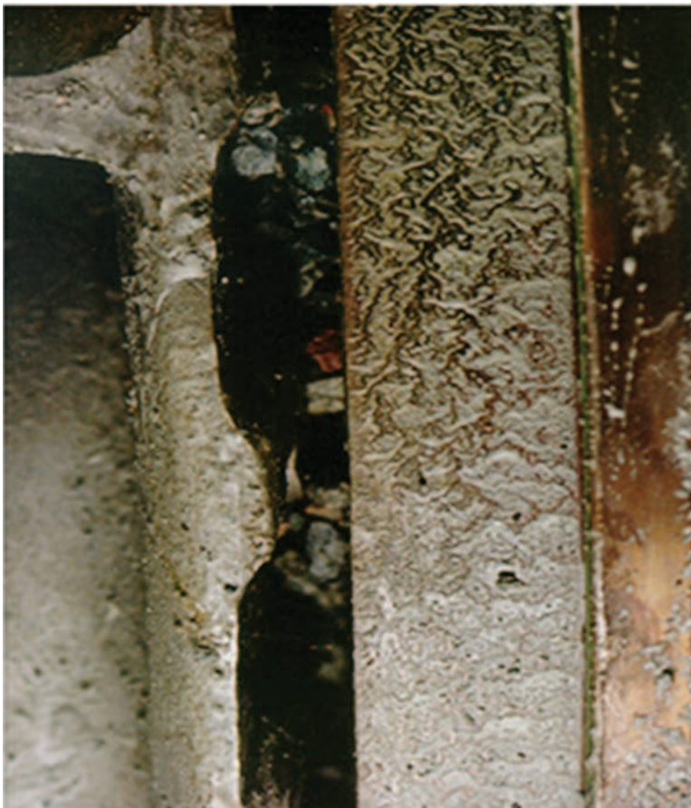
FOT. 3 Częstki materiału uwięzione pomiędzy wirnikiem i korpusem w konstrukcji konwencjonalnej
