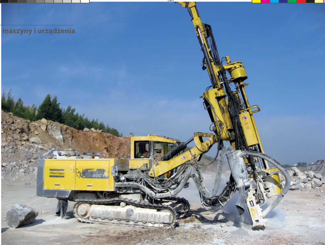
Fot. 2. Praca wiertnicy ROC F9CR w kopalni Nordkalk – Miedzianka S.A.
