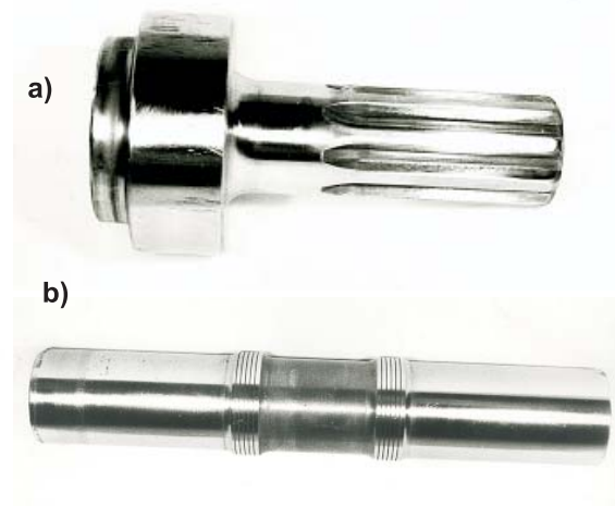
Fot. 1. Kształty tłoków: a) wiertarki pneumatycznej, b) wiertarki hydraulicznej
